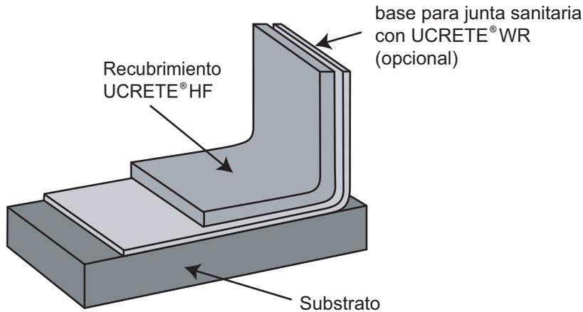
para pisos nuevos y existentes. Mecánicamente, profile el piso por lo menos a 3 CSP (aproximadamente como es determinado por el Instituto Internacional de Reparación del Concreto (ICRI). No use tratamiento con ácido para la preparación de la superficie. No use ningún método que fracture el concreto.
